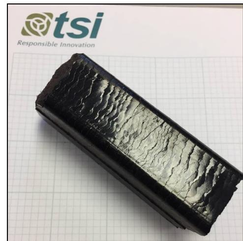
Figure 52: Rotogasifier Biochar
